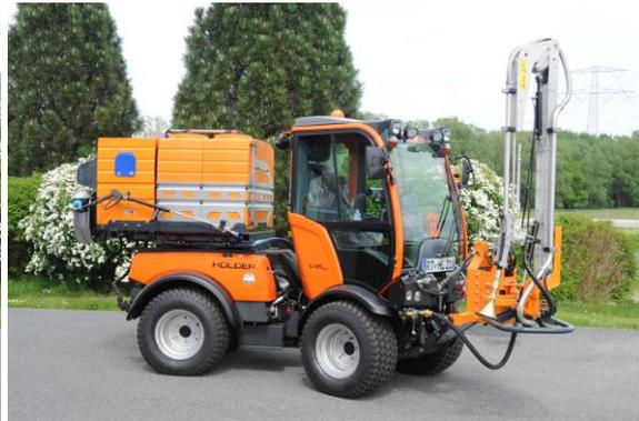
Das FIEDLER Tanksystem FTS 650 mit Option Kombipower und Gießarm. Die komplette Steuerung erfolgt wie bisher über die Fiedler Multimatic Control (FMC).
